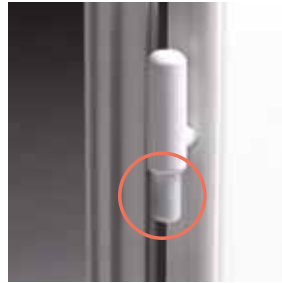
FICHE ARRONDIE AVEC AXE GÂINÉ EN MATIÈRE AUTO LUBRIFIANTE CE QUI ÉVITE LES TRACES NOIRES SUR LES MURS
